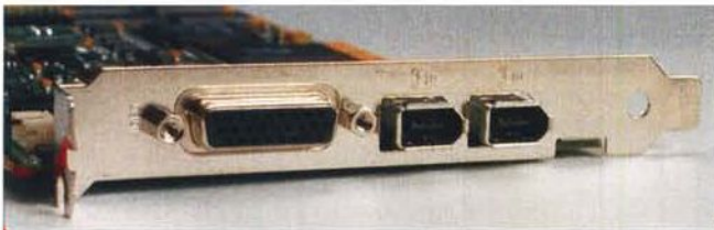
Direttamente sulla scheda sono poste le prese Firewire per l'io in standard DV. Accanto è visibile il grosso connettore multipolare per il collegamento con il box di connessione esterno.
